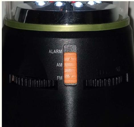
Empfohlen werden hier kurbelbetriebene Kombigeräte, die sowohl Radio als auch die Notbeleuchtung integriert haben. Damit kann durch den Verzicht auf Kerzen die Brandgefahr verringert werden. LEDs geben strahlendes Licht.
